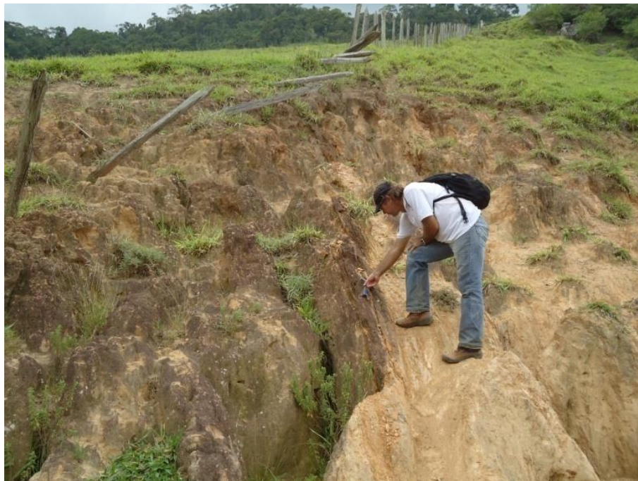
Figura 11- Provável zona de cisalhamento composta por gnaiss alterado (coloração amarela esbranquiçada).
